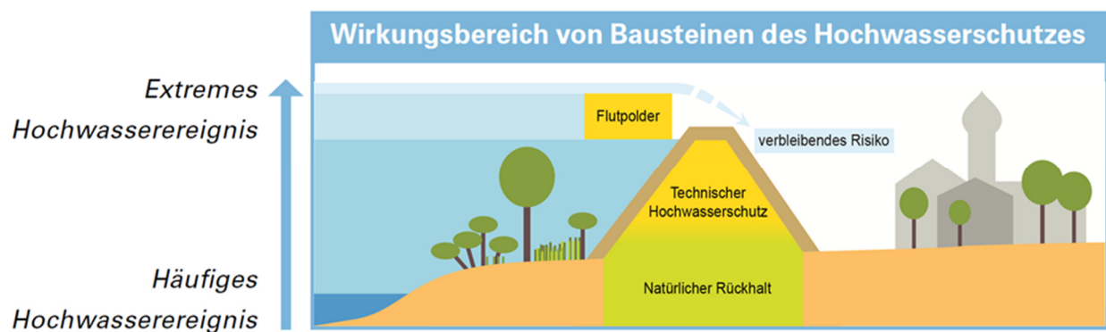
Abbildung 3: Bausteine eines modernen resilienten Hochwasserschutzes
